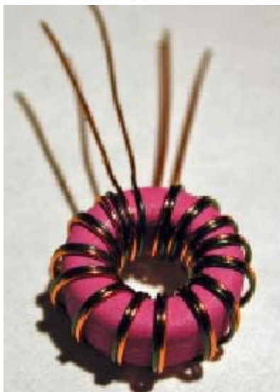
T3 bifilaarikäämi valmiina toroidin rungolla.
